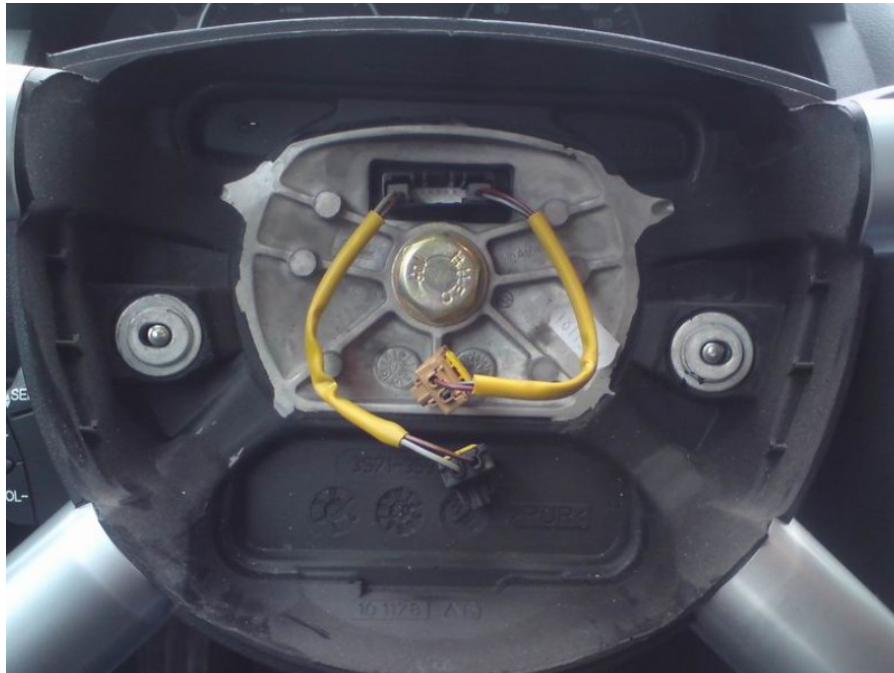
*Fot. 7. Kierownica po odkręceniu modułu poduszki powietrznej.*
